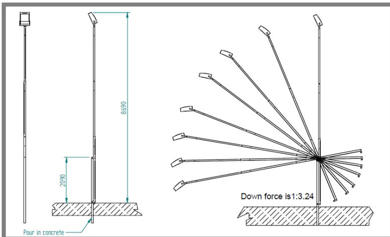
Der Mast ist kippbar und wird in einem Karton 3 m x 0,2 m x 0,1m inkl. der Armatur, der Lampe sowie Kabel als komplettes Montagepaket geliefert. Den unteren Teil des Mastes müssen Sie einbetonieren. Danach können Sie den Mast montieren. Der Mast hat ein Endmaß von ca. 8,5m Höhe.
